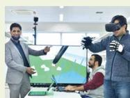
外科医が手術支援ロボットを遠隔操作する「オンライン手術」の普及にむけて、高度なロボット制御を可能にするウェアラブルロボットの研究開発を進めています。手術支援ロボットの扱いを訓練するVR環境や、手術の際に重要かつ今まで導入が難しかった「触覚」を提供するロボットグローブを開発しています。
